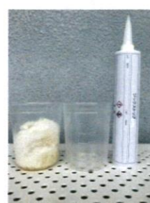
①ジックスストップが水と反応し硬化。 (ゴム状弾性ゲル化)
