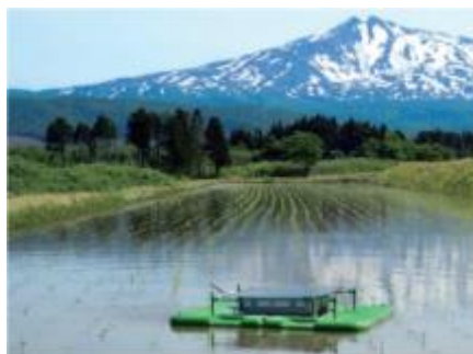
●実装試験中の抑草ロボット
