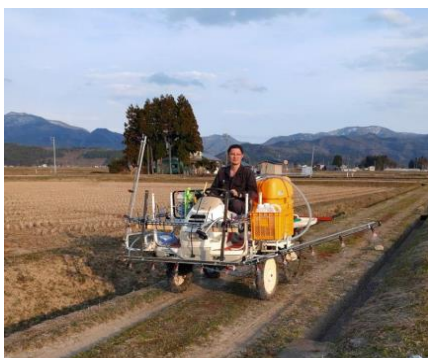
田植機を改造したスプレーヤーで畦畔の除草剤散布作業 ●
