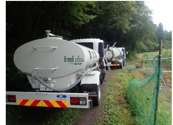
散水車による用水運搬
