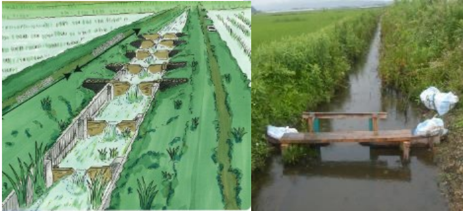
(A) 排水路の堰上げ
