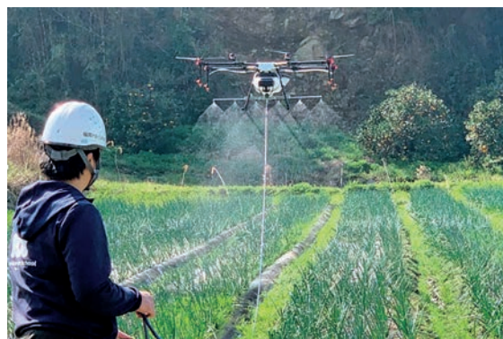
写真2 ドローンによるBio-CLFの散布
