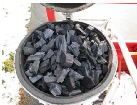
木炭発電装置の窯に木炭を投入
