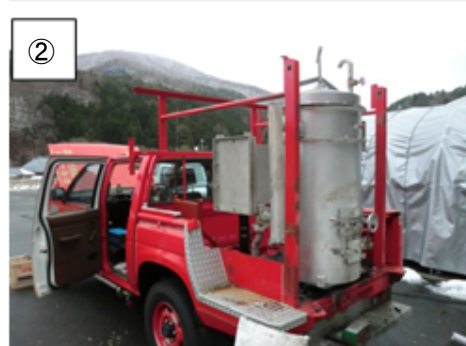
② 背後からみた木炭発電装置 荷台に水性ガス発生装置を積載
