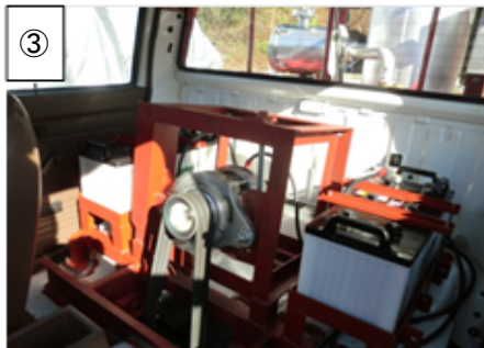
③ 車室の後部座席に発電機(4.8kW)を 積載, 動力は下部の動力伝達シャフトか ら得ている。車両は, 4輪駆動車なので, 前輪用の駆動力で車を走らせることが可 能だが, 陸運局の許可が必要。
