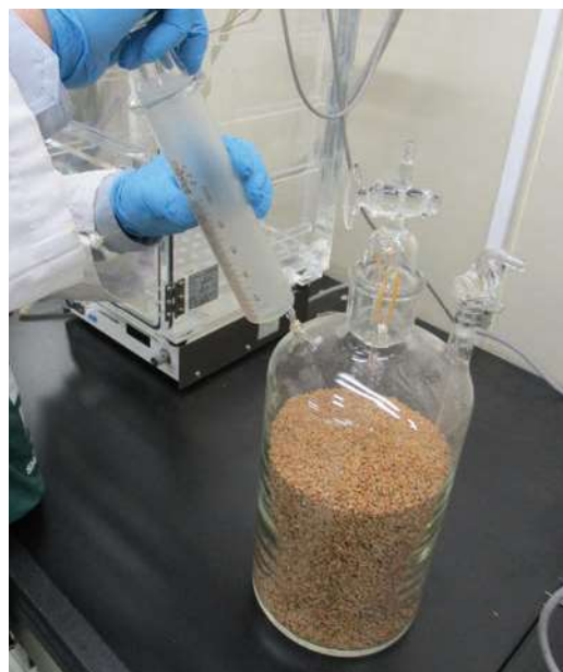
くん蒸剤の投薬作業
