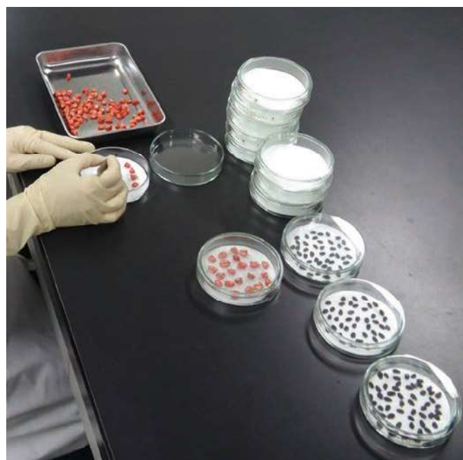
ブロッター法による検査
