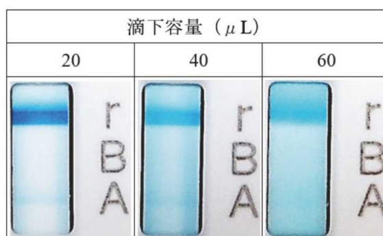
図5 滴下容量を増加させた場合の測定結果 反応カセットに20 \mu L( 10^{4.9} EID 50 )、40 \mu L( 10^{5.2} EID 50 )、60 \mu L( 10^{5.5} EID 50 )の試料液を滴下した。
