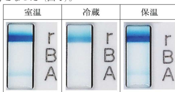
図4 低温条件での測定結果 反応カセットに 10^{4.9} EID 50 の試料液を滴下した。
