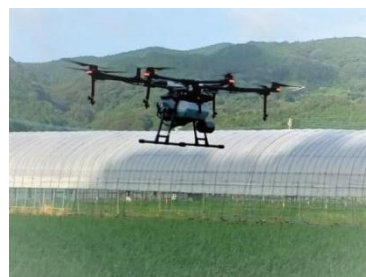
農業用ドローンによる水稻防除の様子→
