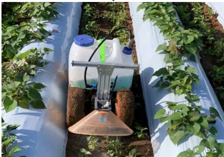
畝間に除草剤を散布しながら直進するウネマキ。（ラジコン操作）
