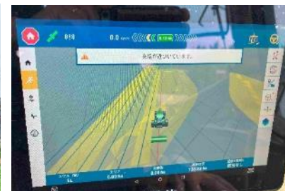
ガイダンスシステム自動操舵による コーン、大豆の播種
