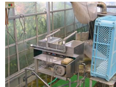
A農園で独自に開発したトレイの洗浄機
