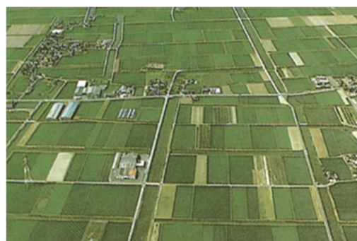
写真：事業後のクリーク (クリークを直線化・整理統合)
