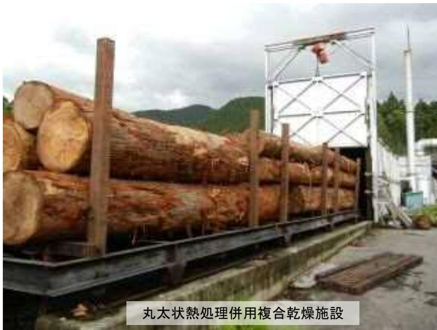
丸太状熱処理併用複合乾燥施設
