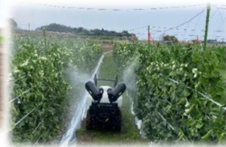
無人自動運転散布車両 による防除
