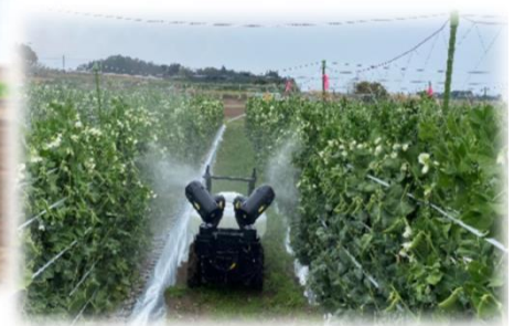
無人自動運転散布車両 による防除
