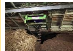
発酵槽での攪拌・発酵
