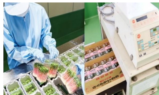
目視、金属探知機での異物混入検査
