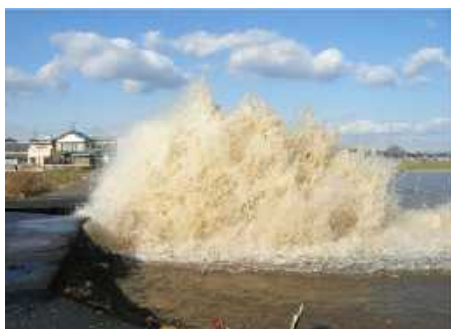
【管水路の突発事故（管の破裂）】
