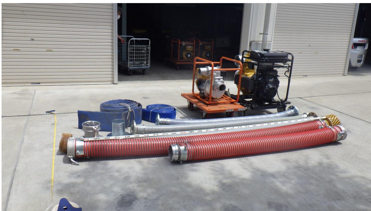
陸上ポンプ（自給式）φ150mm、φ100mmの資機材
