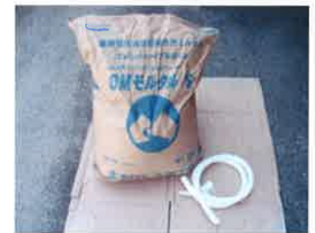
断面修復材 OMモルタル バックアップ材
