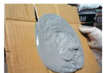
⑧ 段ボールに塗料をあけ 垂直にし塗料が垂れなく なるまで待つ。 (約5分前後)
