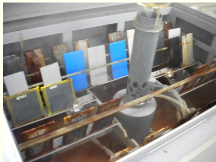
塩水噴霧試験機での試験状況
