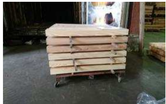
（熱処理用に組み直した杉製材）
