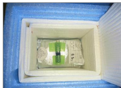
《写真⑲》 冷凍牛肉を入れた保冷バックに温度ロガーを貼り付けて計測
