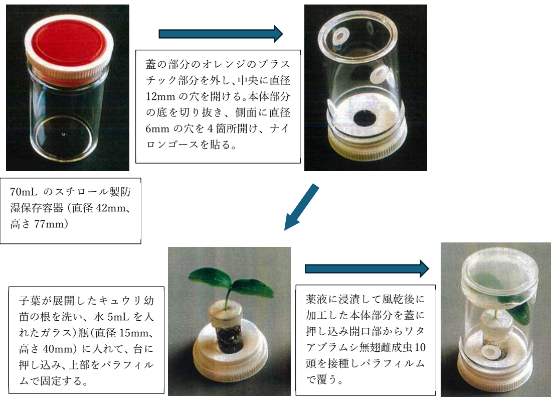
図2. 幼苗浸漬法で用いられる検定容器の例(曾根ら、1998 より引用)。松浦(2016)などで採用されている。
