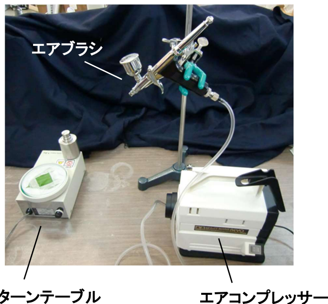
図1. 回転式散布塔に代わるエアブラシ装置(國本ら、2017を改変).
