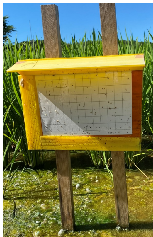
図2 調査用紙（ユポ紙）を黄色い板に張り付けた粘着トラップ
