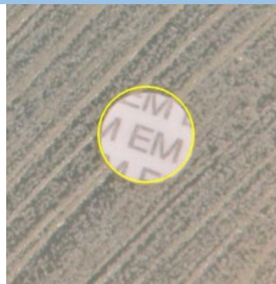
阻止円が確認出来ない例 ディスクの直径(6 mm)を記録する。
