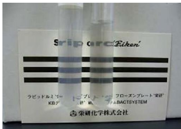
図 3-5 ストライプカードと菌液調整
