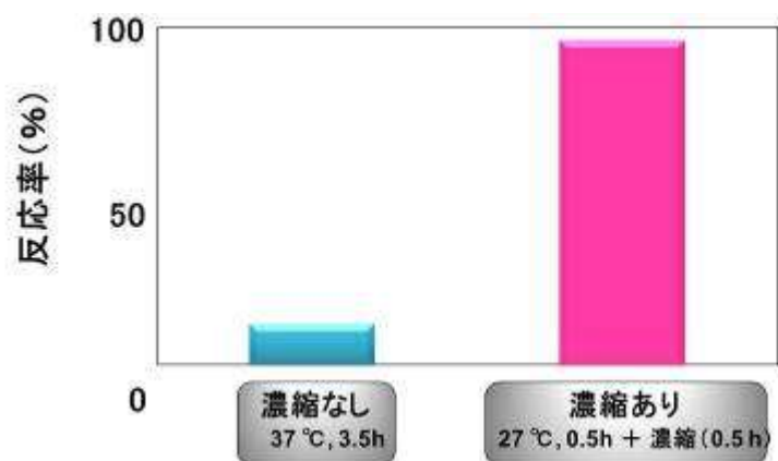
図5. メタノール中 NaOH 不使用条件での AA 誘導体化における濃縮操作有無の比較
