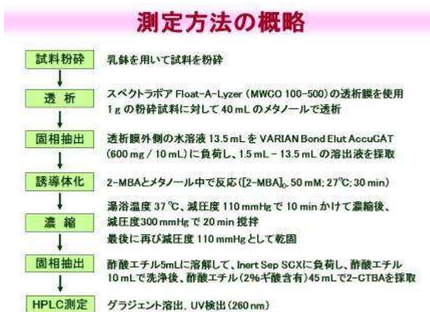
図9. HPLC を用いた AA 分析法の概略 (平成 22 年 11 月時点)
