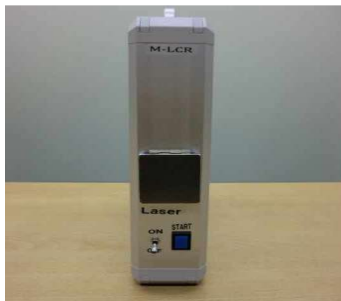
図9 普及版イムノクロマト用測定器のプロトタイプ
