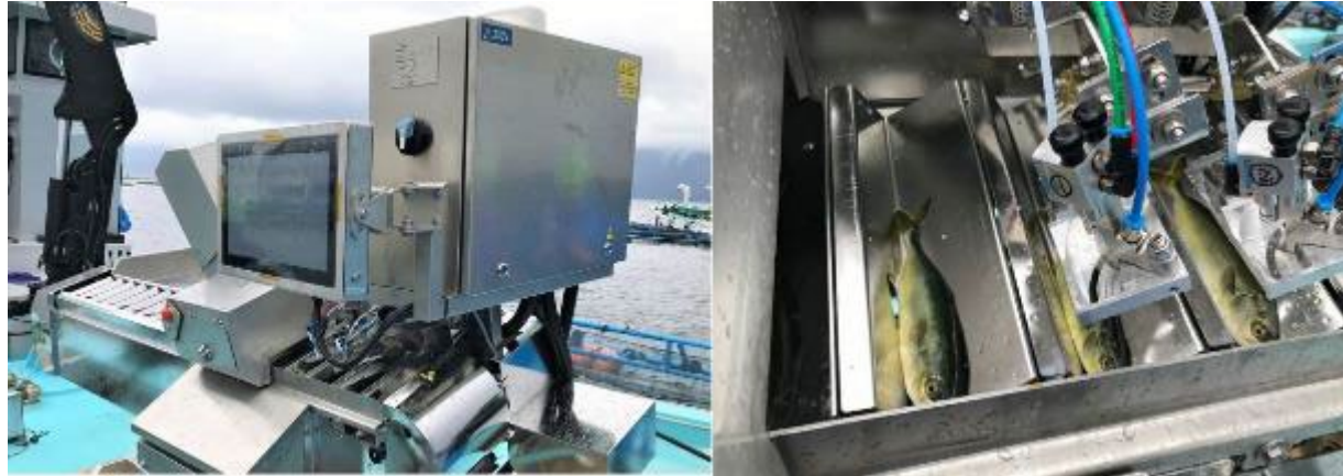
写真： 大手水産会社MN社系列の養殖場で試験中の自動連続接種機
