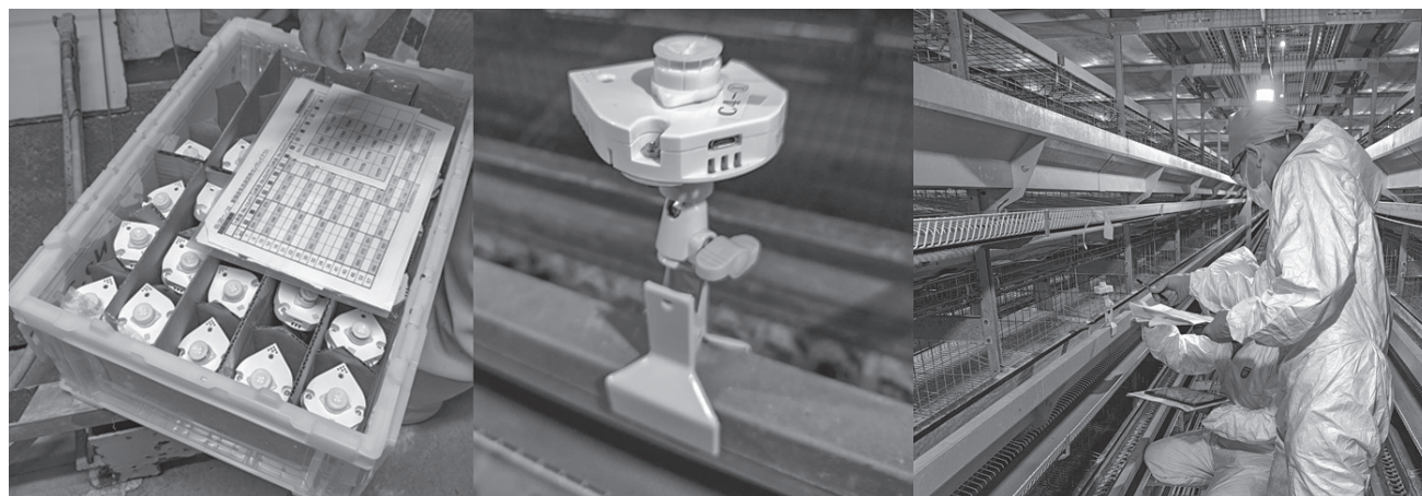
図1 気流測定装置（左）、設置した様子（中）、測定風景（右）
