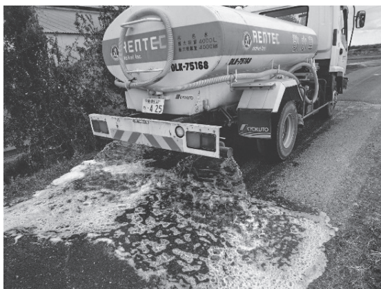
(写真2) 散水車による路面消毒
