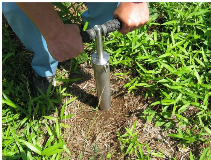
図3 円筒ライナーを挿入し、表層から垂直にハンドルを回して荷重をかける。
