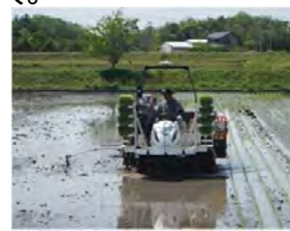
GPSガイダンス&自動 操舵補助付きの田植機
