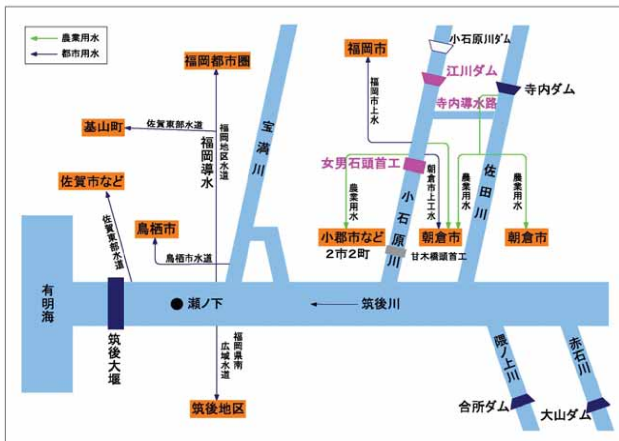
図 1-2 両筑平野用水事業に係る取水模式図
