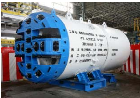
サイホン工事用シールドマシン
