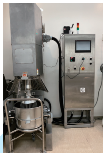
実証事業で使用した ホイップ製造装置
