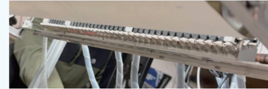
当初検討していたロボットアームによる除去方式からエアガン方式へ転換。それにより、非接触での異物除去、ミリ秒単位の高速度制御、機械構造の簡素化、保守負担・コスト低減、処理能力向上を実現
