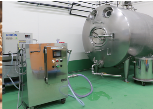
自社開発した特許技術のウルトラファインバブル（UFB）発生装置
