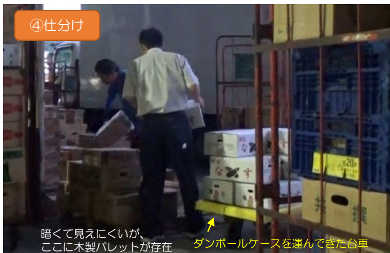
パレット上への分荷の様子 (台車で運搬しパレット上に載せようとしているところ)
