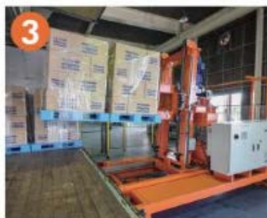
3 トラックの荷台へ積み込み
