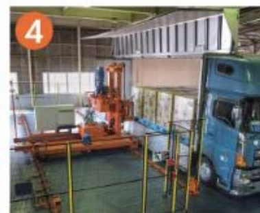
4 パレット間のすき間なく積み込んでいく
