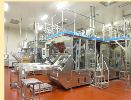
↑導入した1ℓ牛乳パックの充填機
