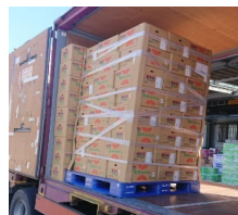
(荷崩れ防止策)
