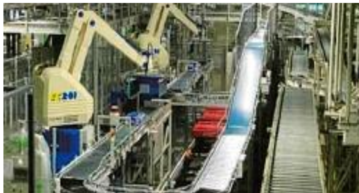
多様な積付けパターンにも対応可能な ロボットパレタイザー
