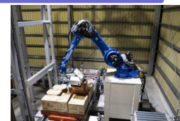
ピッキングロボット
