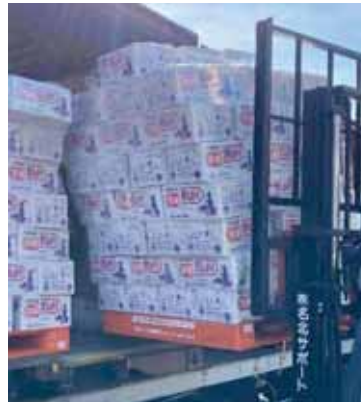
片寄ったパレットを慎重に降ろす。 隣のパレットと接触しておらず、リフト作業が可能であった。
