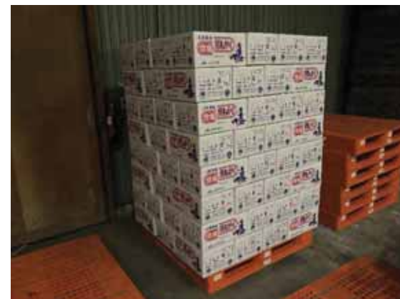
パレットへの積み付け (12本バイ×8段=96ケース)
