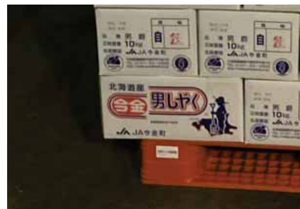
11型パレットにDBサイズが適合していないため、パレットからはみ出ている。
