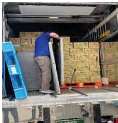
隣接する荷物との間に緩衝材を設置
