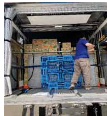
緩衝材とラッシングバー、持参のパレットで固定
