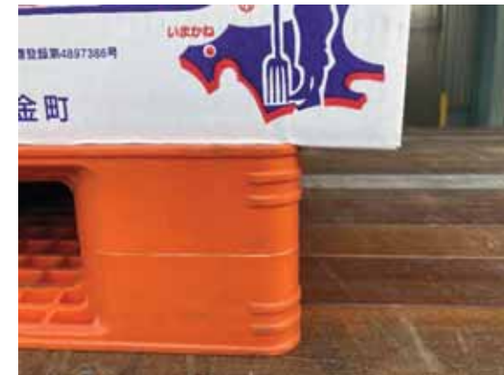
11型パレットにDBサイズが適合していないため、パレットからややはみ出ている。
