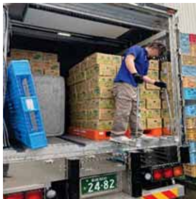
パレットローラー（ジョルダー）で車両奥へ
