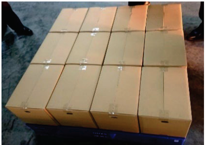
11型パレットへの 積付けパターン
