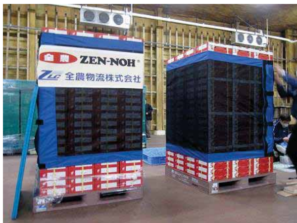
従来の樹脂パレット (左) と防振パレット (右)
