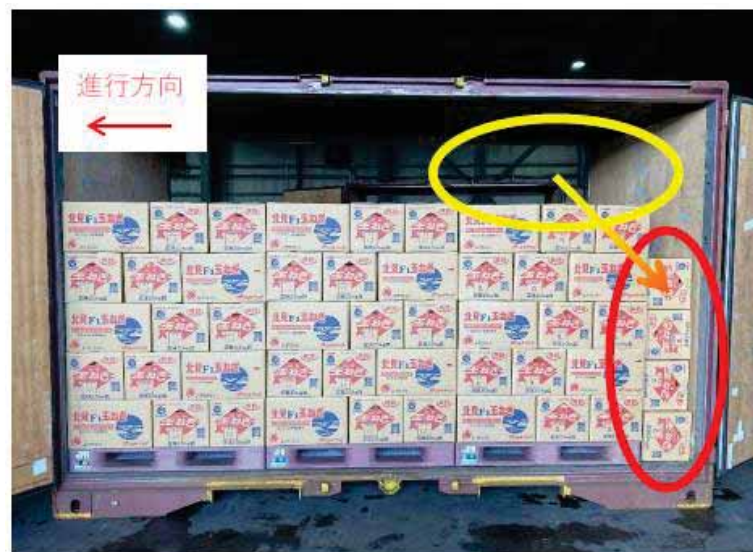
輸送中の荷崩れ防止のため、黄○部のケースを赤○部に落とし込む。
