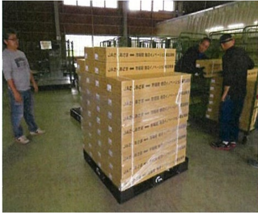
荷崩れ防止のため、7段でフィルム巻き
