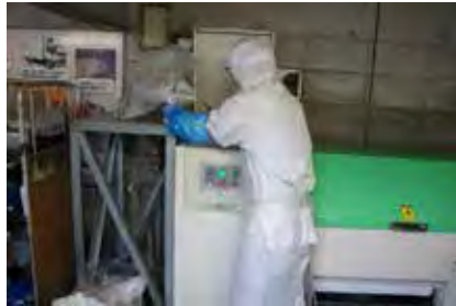
異物分離・粉碎機への投入
